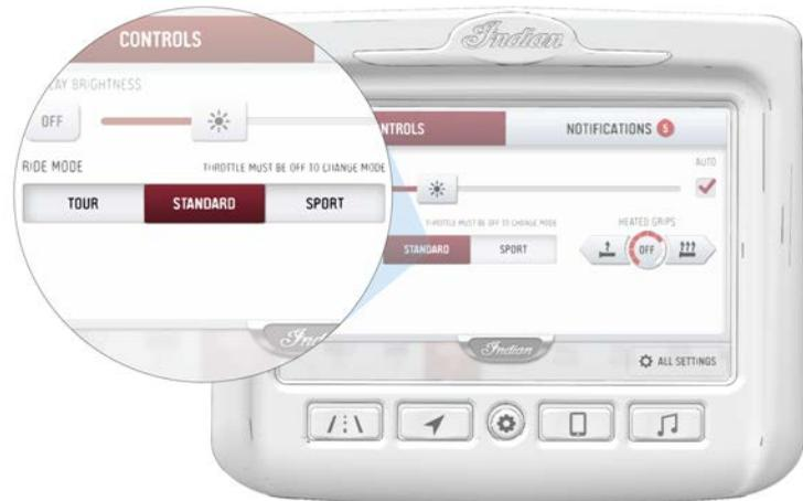
ライダーの運転スタイルに合わせて、(Tour, Standard, Sportツアー、スタンダード、スポーツ)の3種のライドモードが選択できます。各ライドモードのスロットルマッピングは、路面や走行状況の違いを念頭において設計されているため、1台のモーターサイクルに3種類の異なる個性を持たせることができます。
