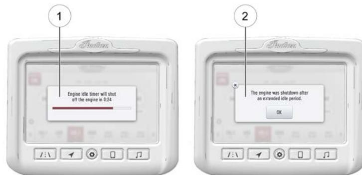
ライドコマンド装備車の場合、エンジン停止を警告するカウントダウンタイマーが表示されます①。残り時間がゼロになってエンジンが停止する場合、その通知が表示されます②。エンジン停止後もスタータースイッチを押せばエンジンを再始動することができます。
