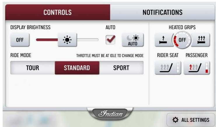
コントロールパネルから、各種設定、ディスプレイ明るさ調整、ライドモードの選択、車両空調操作が可能です。
